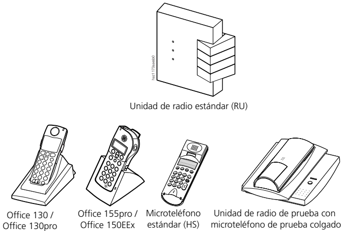
Fig. 3.12: Los componentes de un sistema neris DECT
